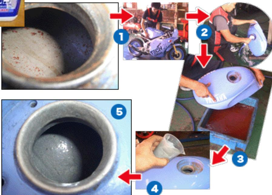
錆び付いてしまったガソリタンクの錆とり&コーティング作業をやっています。錆とりは、ピカタンZをお買い上げただけで自分でもできるのですが、とにかく手間がかかります。キャップを外して、空にして、錆とりをして、洗って、乾かして、さらに中をコーティングする、という根気のいる作業です。古いバイクやほうっておいたバイクのガソリタンクの錆で悩んでいる方は、まずはご相談下さい。
