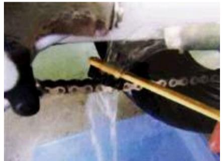
5.使用する前に缶を良く振り、ワコーズ チェーンループをチェーンに吹き付けて10分程放置して下さい。
